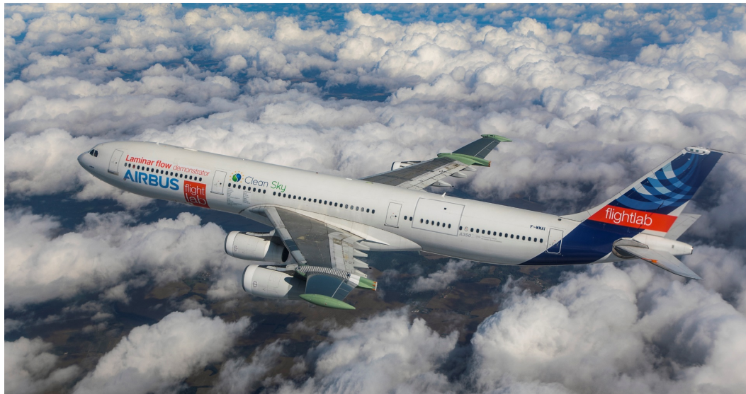
Laminärströmning med Saab-vingen, flygprov
